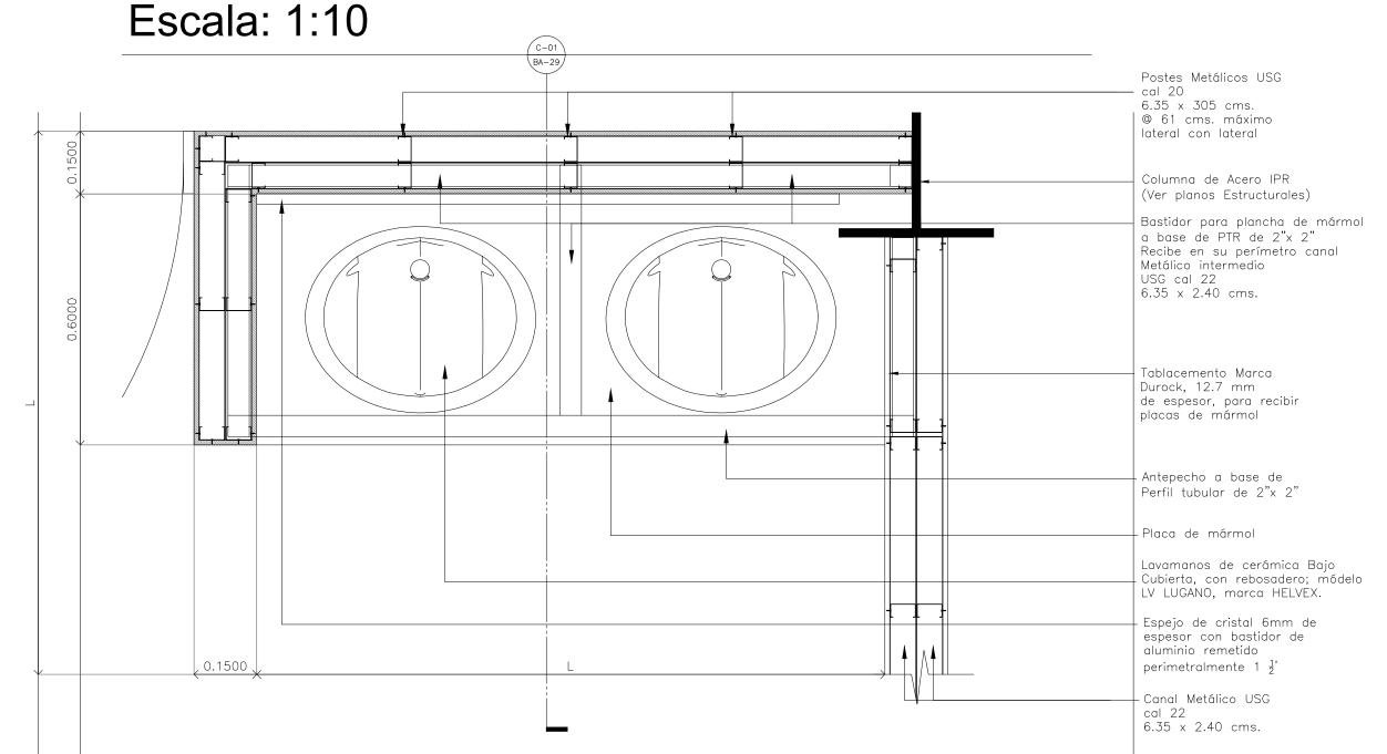
D-02 PLANTA DETALLE TIPO - Por bastidor superior Escala: 1:10
