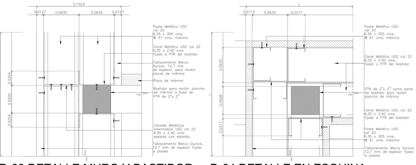
D-03 DETALLE MURO Y BASTIDOR D-04 DETALLE EN ESQUINA Escala: 1:2
