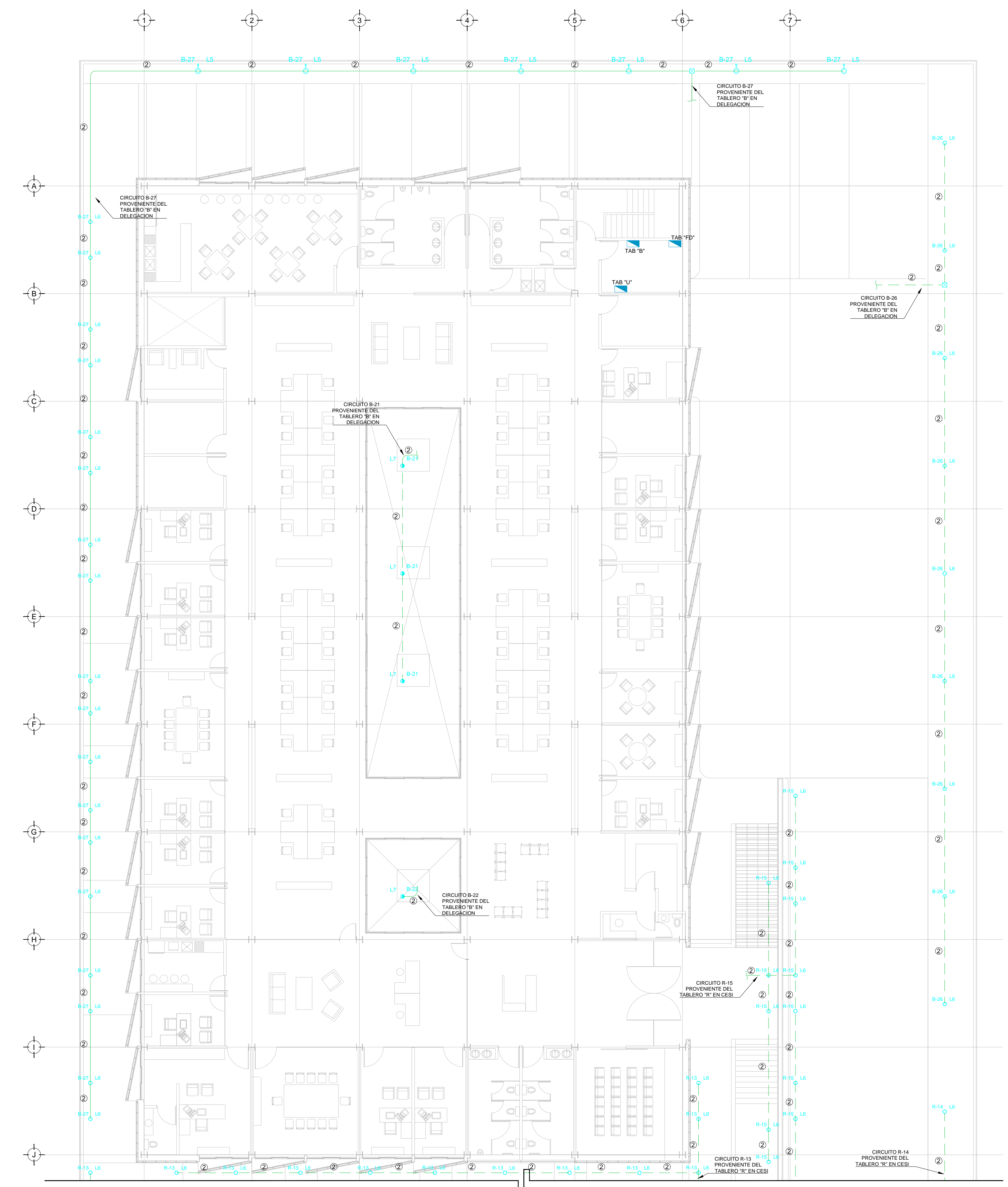
TENDIDO DE INSTALACIÓN ELÉCTRICA (LUMINARIAS EXTERIORES) N.P.T. +3.00mts. ESC. 1:125
