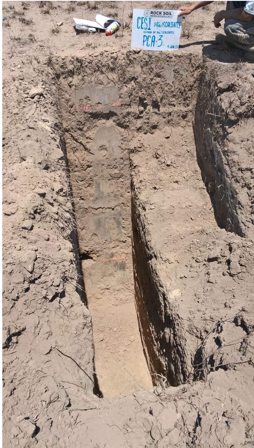
Trabajos de exploración del Pozo a cielo abierto PCA-3.
