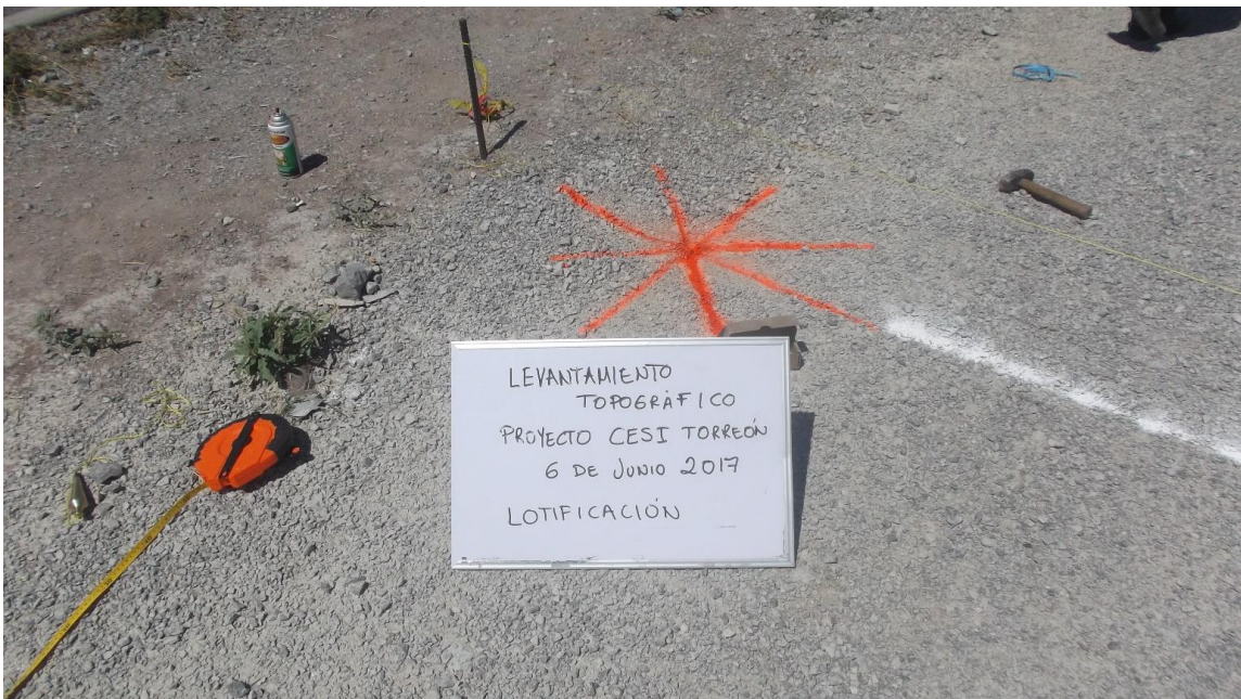
Figura 4.15 Vértice marcado en cada lotes en la parte sur del predio, sobre la avenida Juárez.
