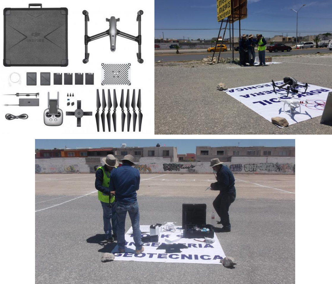
Figura 3.5 Componentes del drone Inspire 2.
