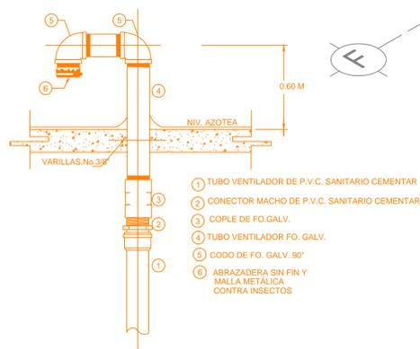
01 DETALLE DE INSTALACIÓN DE REMATE DE VENTILACIÓN
