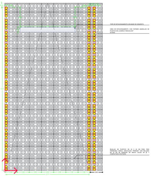
C1 DESPIECE CAJÓN DE ESTACIONAMIENTO ESC: 1:25
