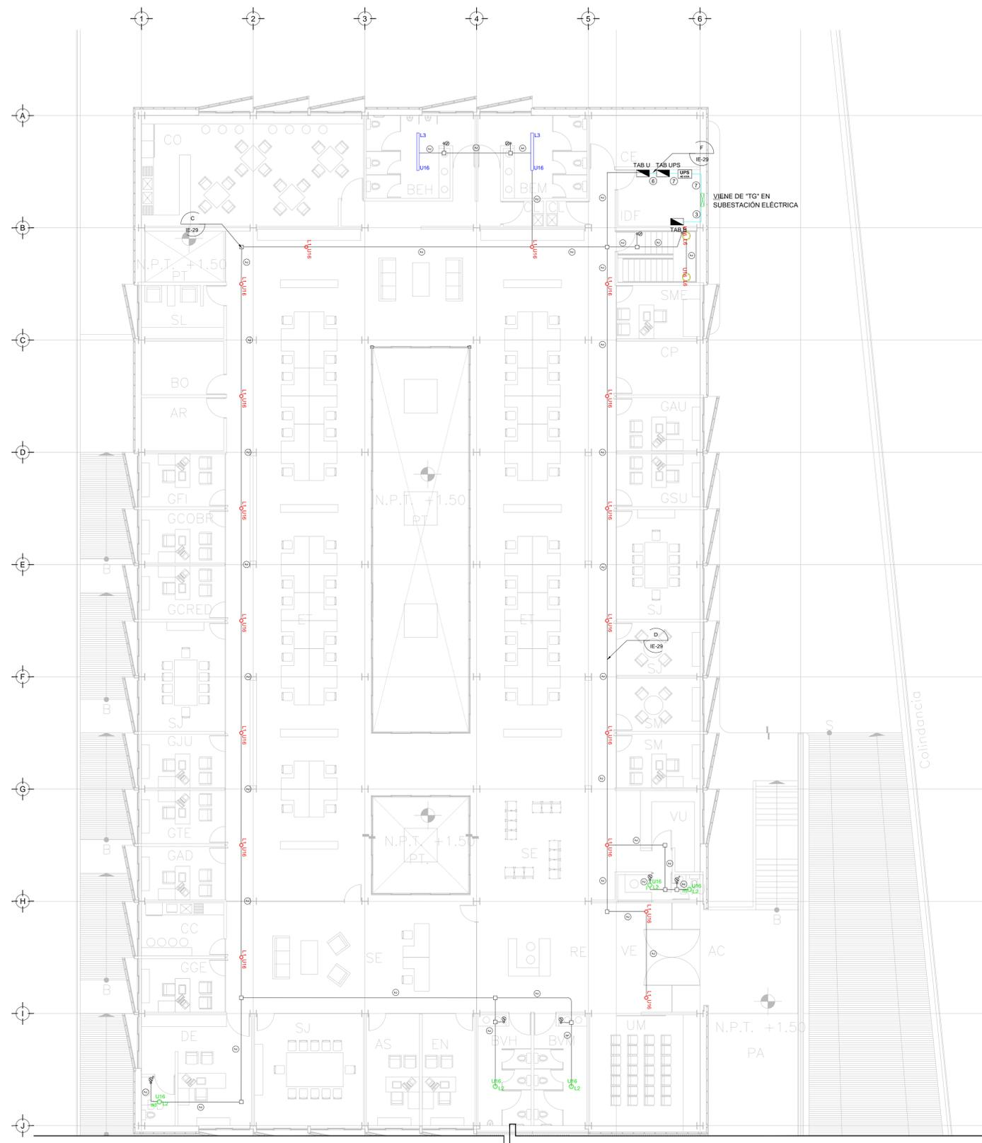
TENDIDO DE INSTALACIÓN ELÉCTRICA (LUMINARIAS EMERGENCIA) N.P.T. +1.50mts.
