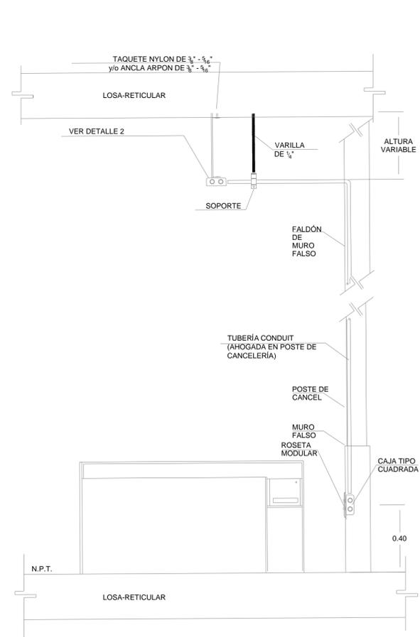
**ALZADO DE INSTALACIONES DE VOZ Y DATOS EN MURO FALSO**
