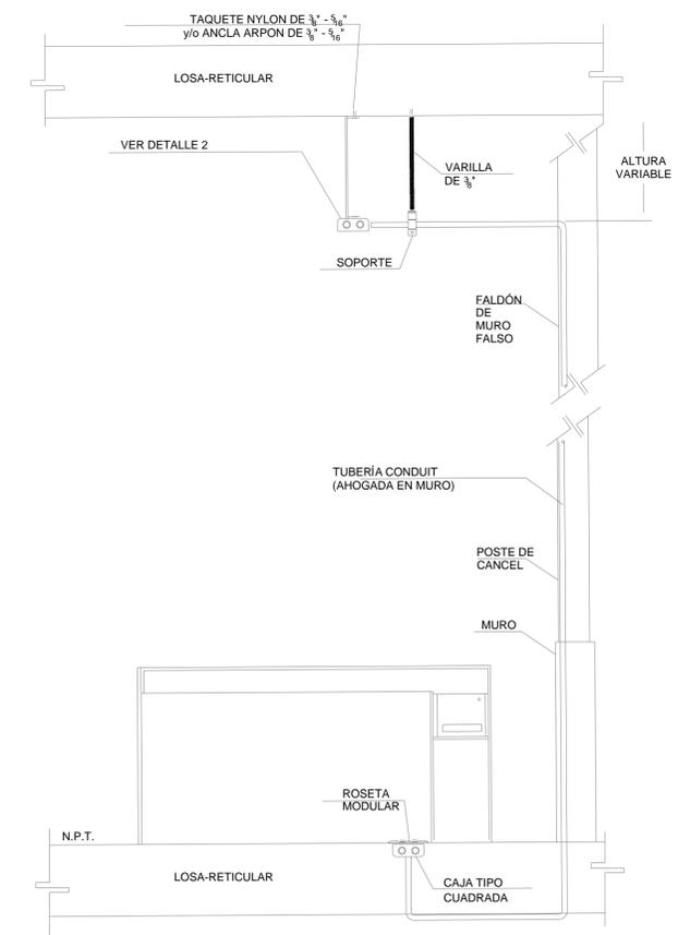
**ALZADO DE INSTALACIÓN DE VOZ Y DATOS EN PISO**
