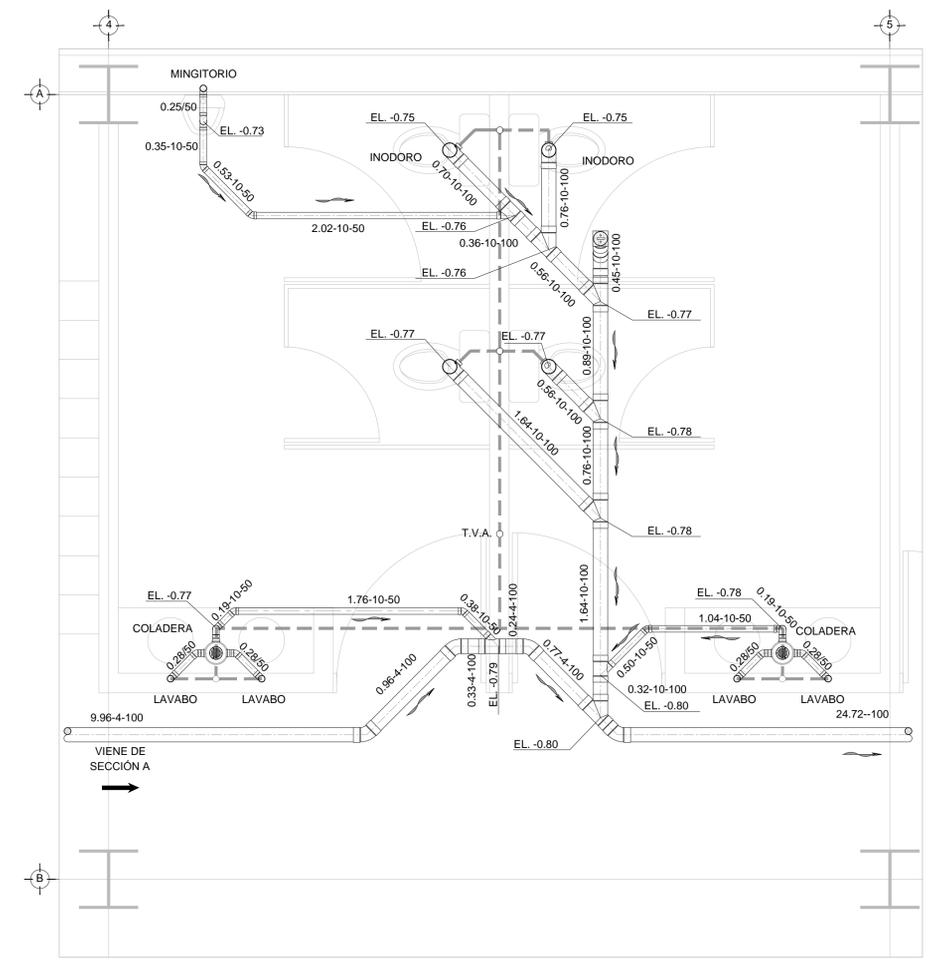
PLANTA BAJA - SECCIÓN B - DISTRIBUCIÓN DRENAJE SANITARIO NIVEL +0.00 ESC: 1:25
