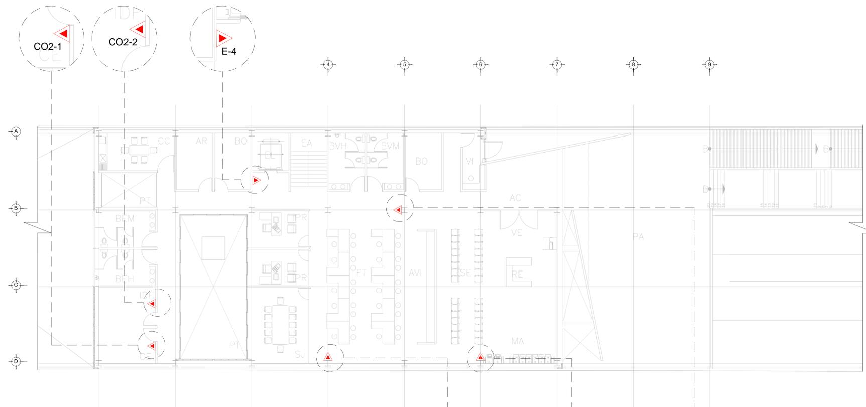
PLANTA BAJA- NIVEL +3.00 INSTALACIÓN DE PROTECCION CONTRA INCENDIO
