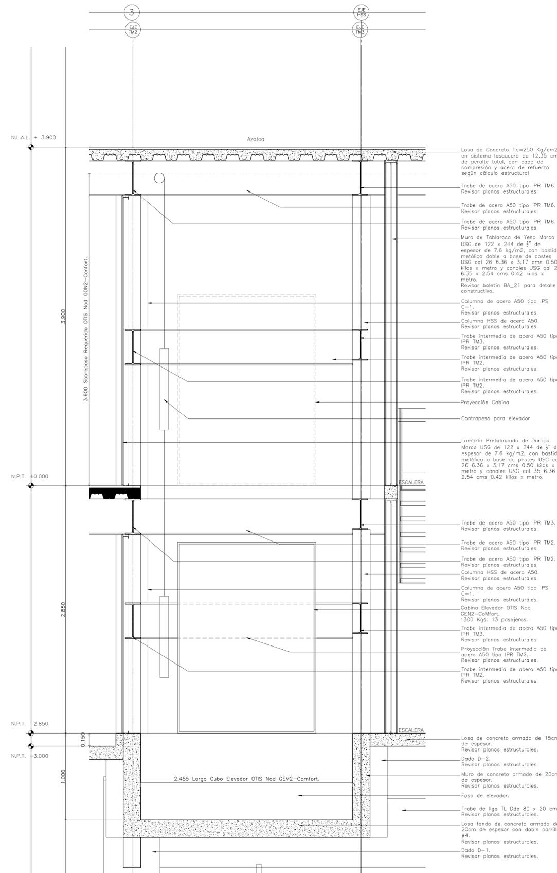
**Corte C-A Detalle de Elevador Escala 1:20**
