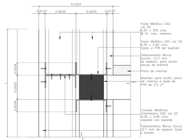
**D-03 DETALLE MURO Y BASTIDOR**
