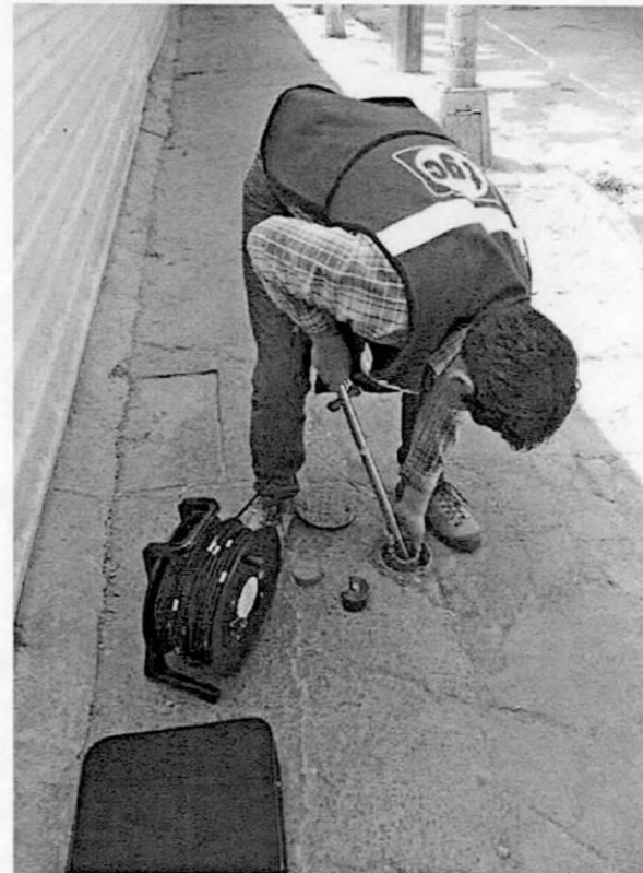
Foto 1 y 2. Colocación de sonda en sitio de tubería de inclinómetros
