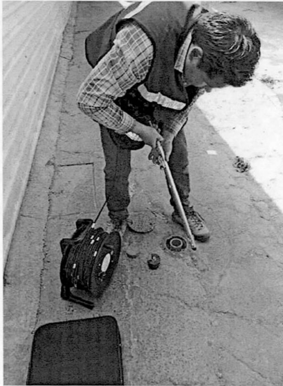
Foto 1 y 2. Colocación de sonda en sitio de tubería de inclinómetros
