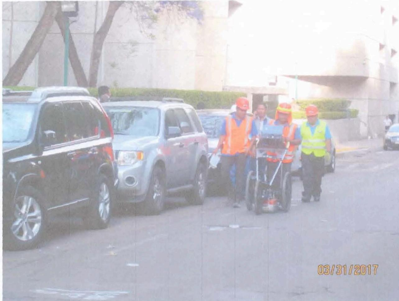
LEVANTAMIENTO DE LÍNEA LONGITUDINAL, CALA VIRTUAL CON UNA PROFUNDIDAD DE 7 MTS. CON EQUIPO ELECTRÓNICO GEORADAR EN CALLE GUSTAVO E. CAMPA.
