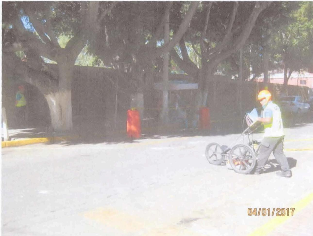
LEVANTAMIENTO DE CALA VIRTUAL CON UNA PROFUNDIDAD DE 7 MTS. CON EQUIPO ELECTRÓNICO GEORADAR EN ÁREA DEL TÚNEL CON UNA LONGITUD DE 13.60 MTS. EN LA CALLE GUSTAVO E. CAMPA.
