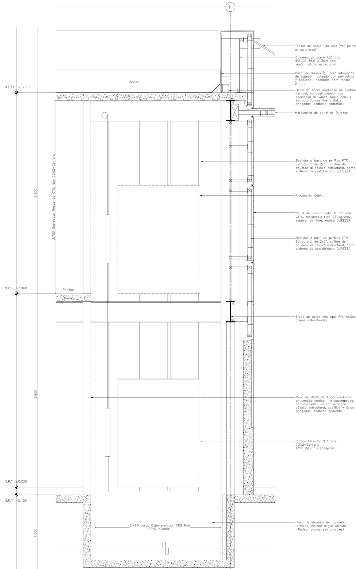
Corte C-A Detalle de Elevador Escala 1:20
