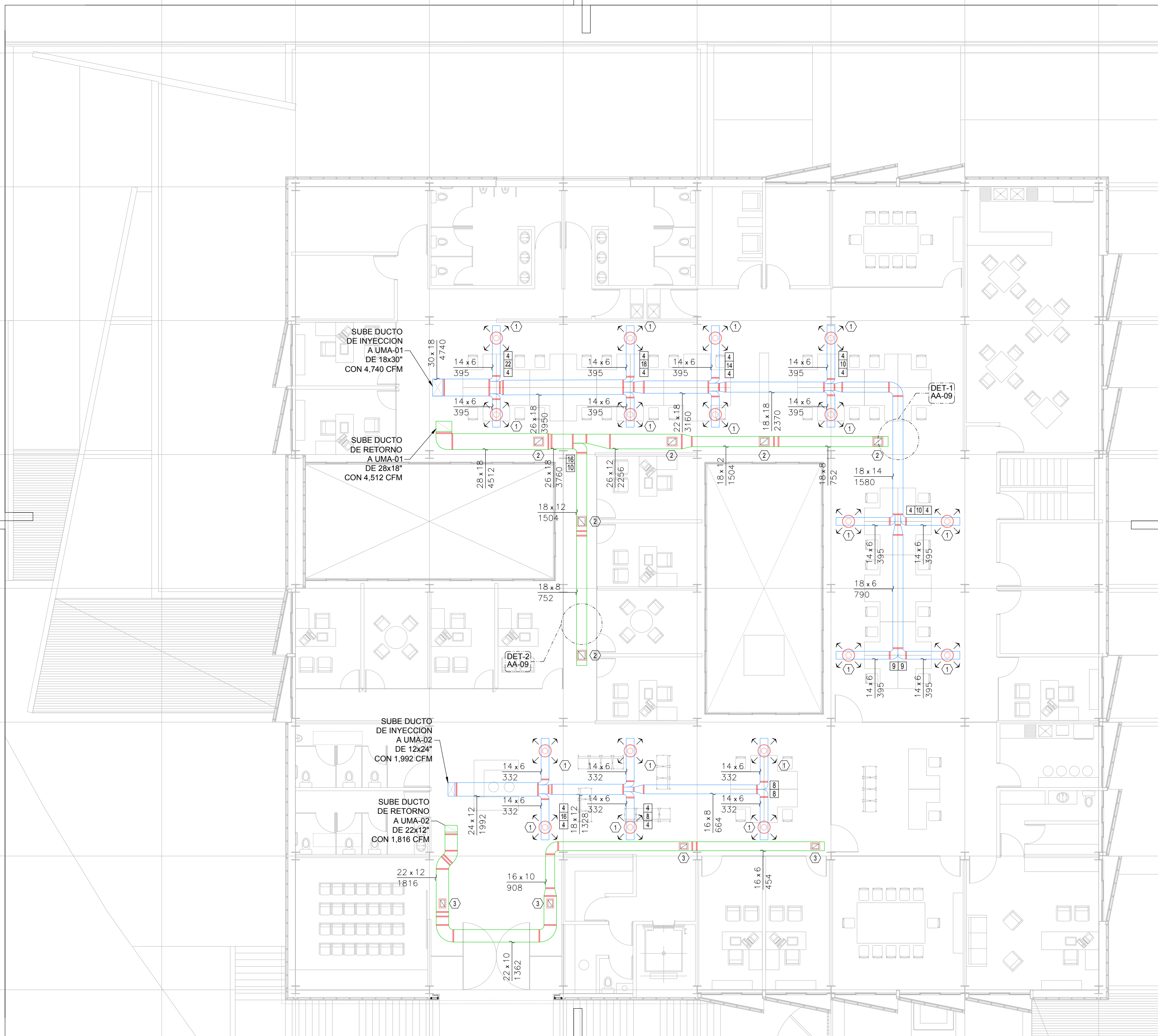
DISTRIBUCIÓN DE DUCTOS DE AIRE PLANTA ALTA N.P.T. +4.05m ESC. 1:125
