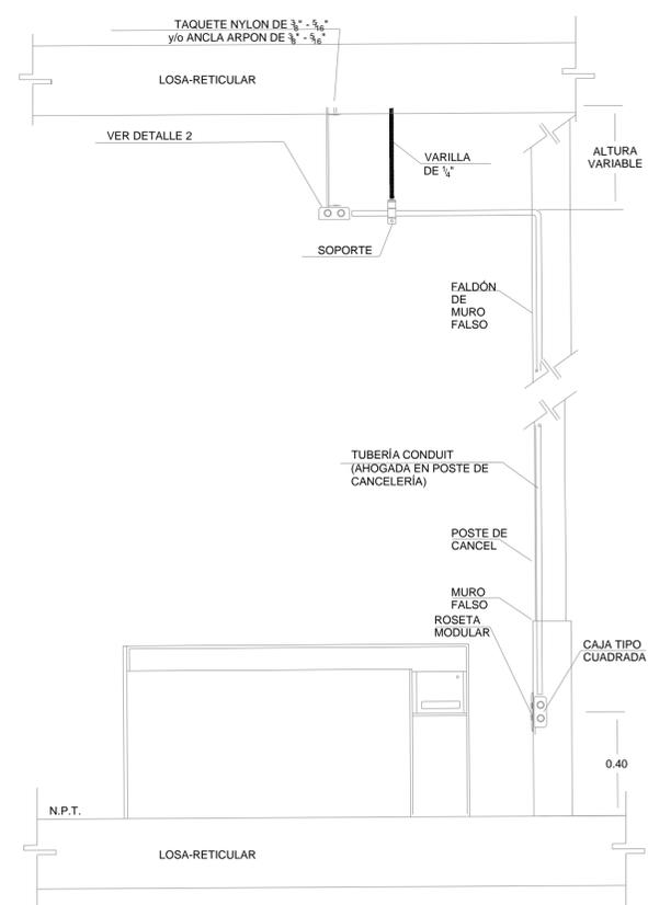
ALZADO DE INSTALACIONES DE VOZ Y DATOS EN MURO FALSO
