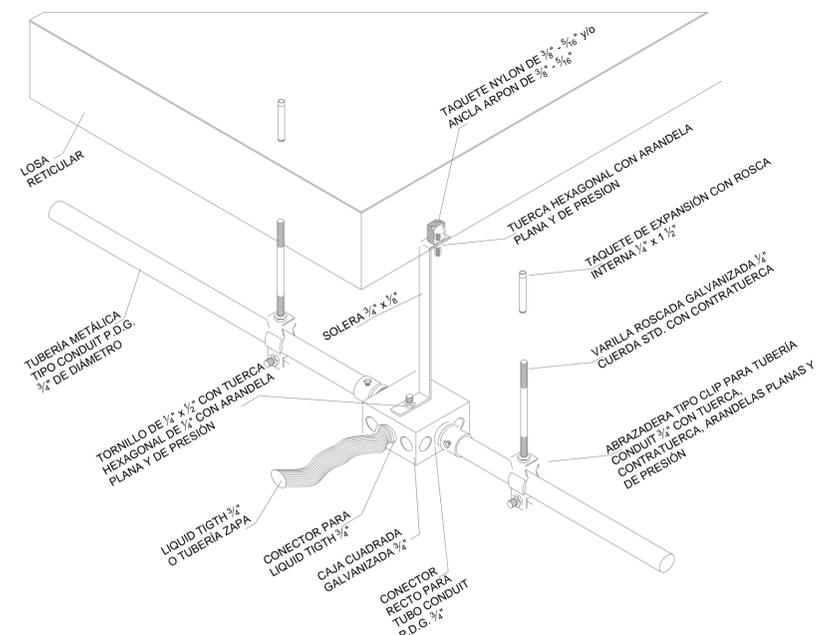
ISOMÉTRICO TÍPICO DE CANALIZACIÓN EN TUBERÍA CONDUIT FIJADA A LOSA
