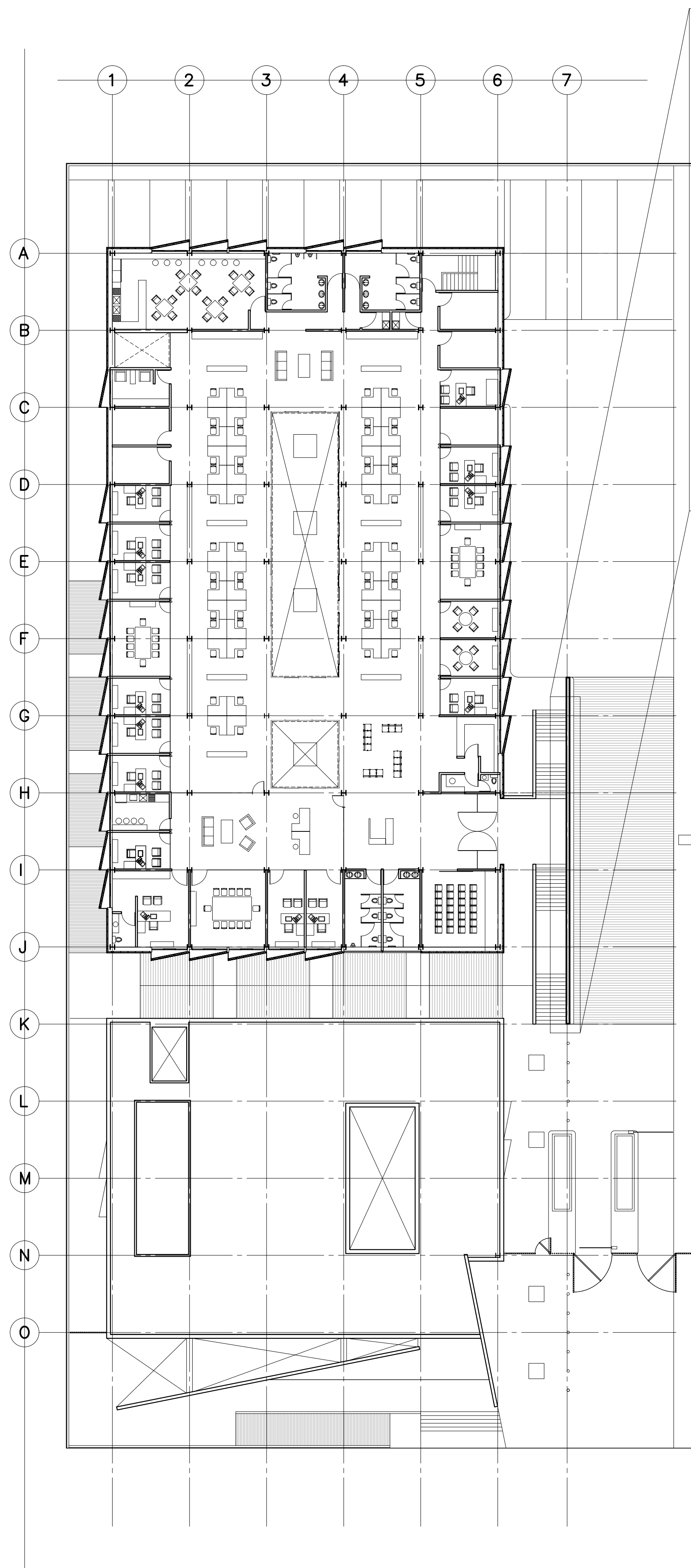
PLANTA ARQUITECTÓNICA UBICACIÓN DE ESCALERAS EXTERIORES
