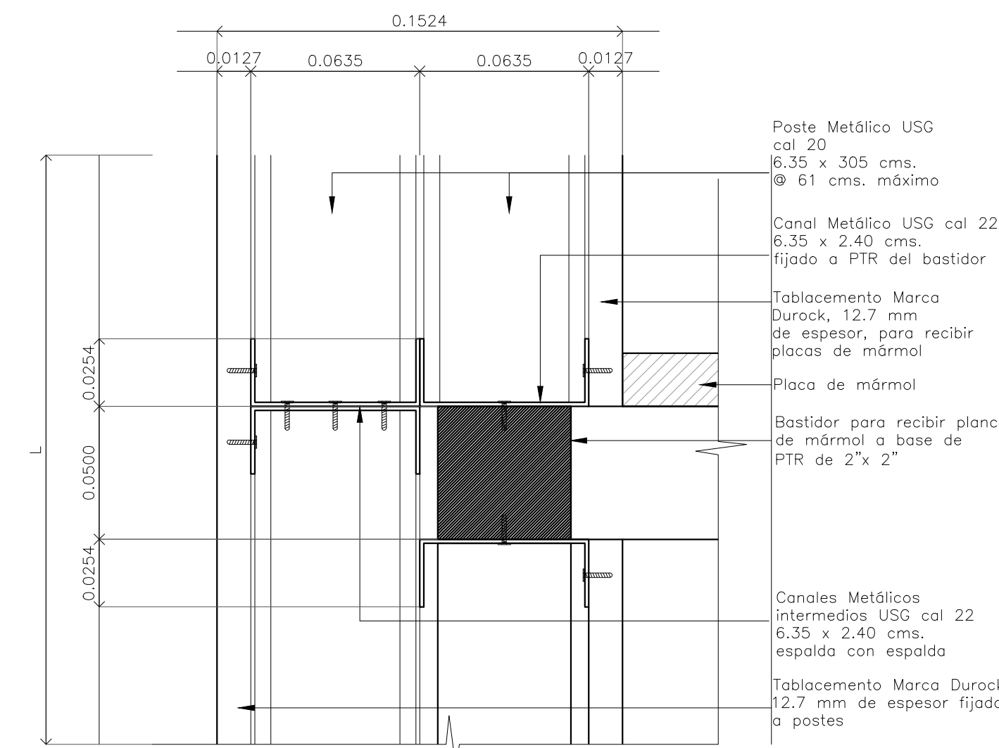
D-03 DETALLE MURO Y BASTIDOR Escala: 1:2
