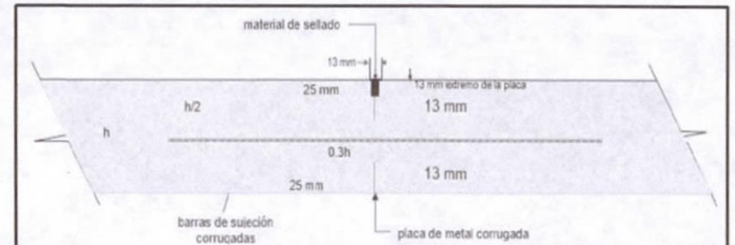
JUNTA DE CONSTRUCCIÓN MACHIHEMBADA
