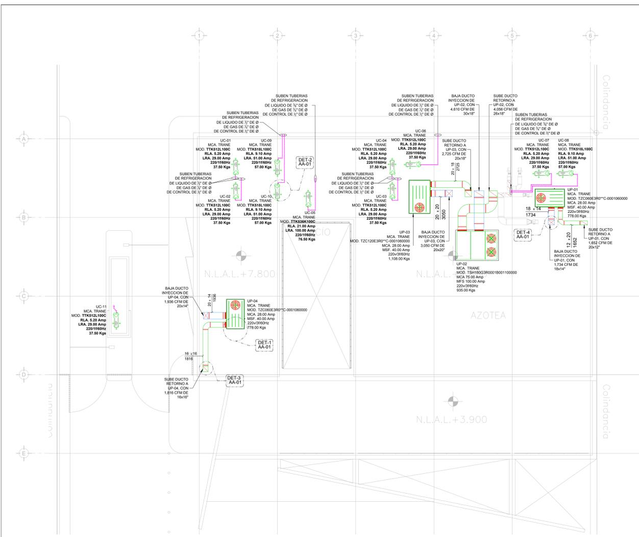
DISTRIBUCIÓN DE EQUIPOS DE INYECCIÓN DE AIRE PLANTA AZOTEA N.L.A.L. +7.80m ESC: 1:125
