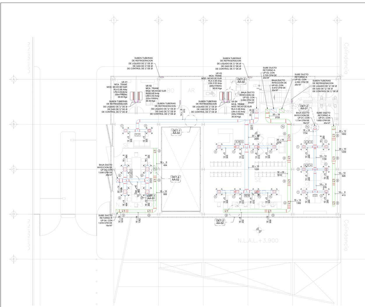
DISTRIBUCIÓN DE EQUIPOS DE INYECCIÓN DE AIRE PLANTA ALTA N.P.T. +3.90m
