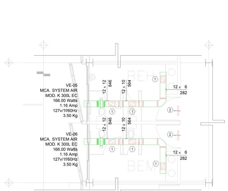
DISTRIBUCIÓN DE VENTILADORES DE EXTRACCIÓN EN BAÑOS PLANTA BAJA N.P.T. ±0.00m
